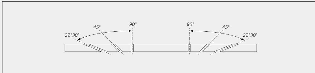
Mechanische Einstellung der Zwischenwinkel
