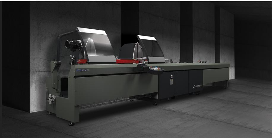
Elektronische Doppelgehrungssäge mit mittels NC-gesteuertem Brushless-Motor automatisch verfahrbarem Sägeaggregat. Pneumatisches Neigen der Schneideeinheiten von 90° bis 22°30' (außen) mit mechanischem System zur Einstellung der dazwischen liegenden Gehrungswinkel. Hydropneumatischer Sägeblattvorschub.
