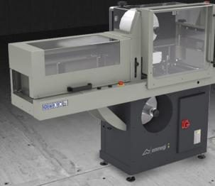
Maschine zum Anbringen einer Schutzfolie an Aluminiumprofilen. Der Profilver Schub erfolgt automatisch über motorisch angetriebene Walzen, und die perfekte Haftung der Folie am Profil wird durch Andruckrollen gewährleistet. Mit einem optionalen Bausatz besteht außerdem die Möglichkeit, eine dritte Profilseite gleichzeitig mit der Folie zu beschichten.
