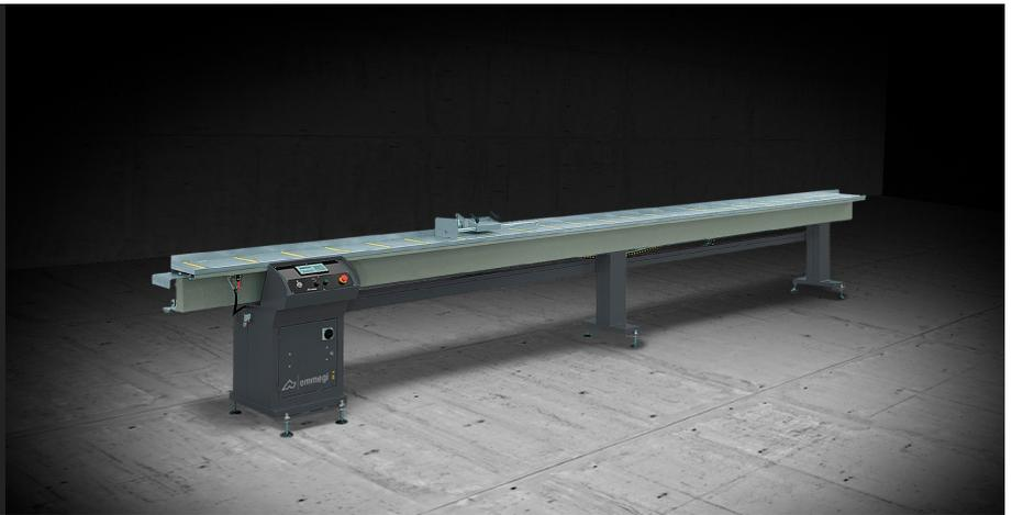
Anschlagsystem für die Profilmessung und -auflage mit durch Wechselstrommotor bewegten Anschlag und elektronischer Erfassung mittels Encoders. Genauigkeit der Wiederholbarkeit  $\pm 0,3$  mm.
