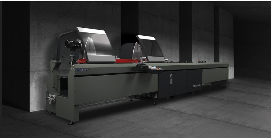
Elektronische Doppelgehrungssäge mit mittels NC-gesteuertem Brushless-Motor automatisch verfahrbarem Sägeaggregat. Pneumatisches Neigen der Schneideeinheiten von 90° bis 22°30' (außen) mit mechanischem System zur Einstellung der dazwischen liegenden Gehrungswinkel. Hydropneumatischer Sägeblattvorschub mit einem Sägeblatt von 500 mm. Erhältlich mit einer Nutzschnittlänge von 4 oder 5 m.
