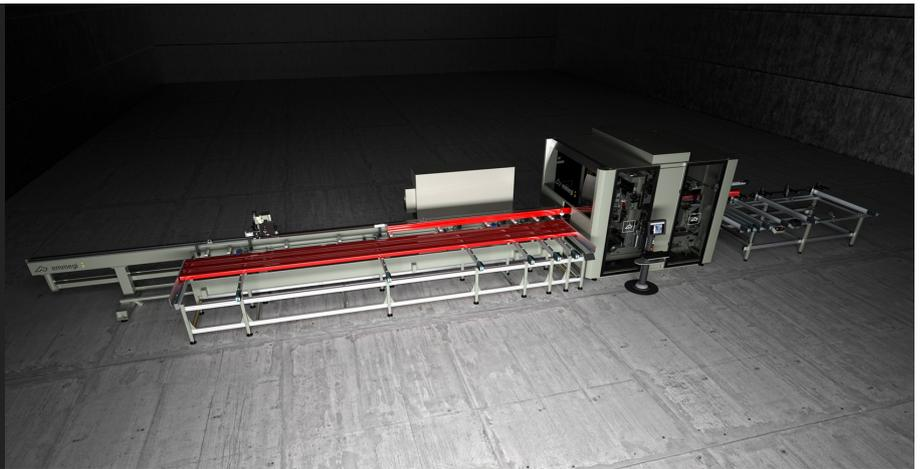
Bearbeitungszentrum mit 12 CNC-gesteuerten Achsen zum Fräsen, Bohren und Schneiden von Profilen aus PVC und Leichtmetalllegierungen.
