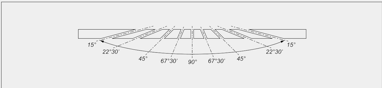
Réglage mécanique des angles intermédiaires
